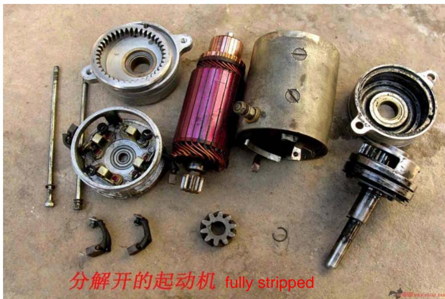
分解开的起动机 fully stripped
