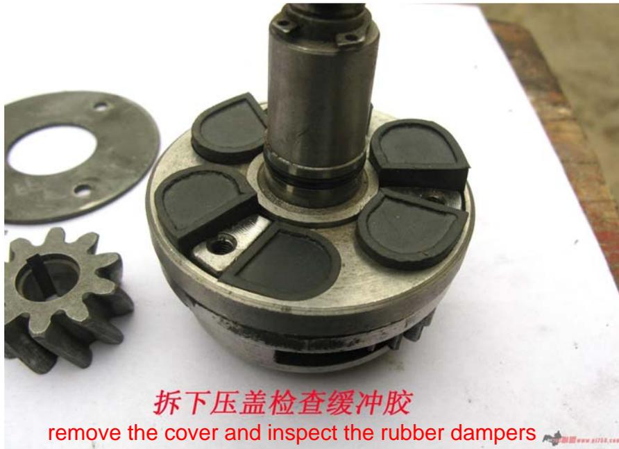
拆下压盖检查缓冲胶
